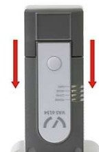
Figura 13) Insertar la interfaz de diagnóstico en la estación base
