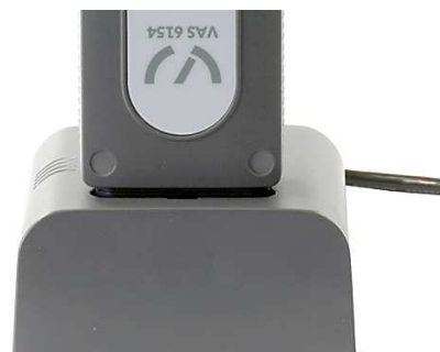
Figura 76) Interfaz de diagnóstico en la estación base
