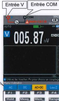
Activez V. Puis, par appui sur F1/F2/F3, activez le couplage DC ou AC+DC. Mesure directe avec graph.
