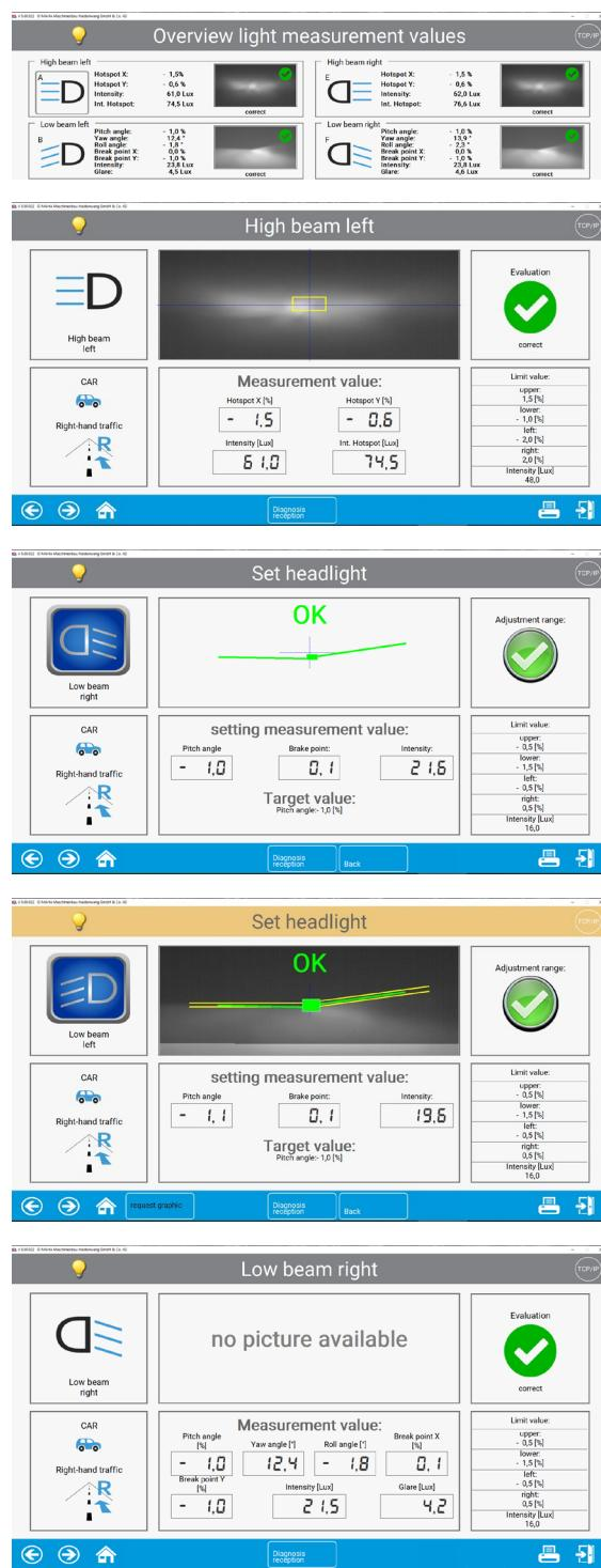
Aparece un resumen de los valores de medición. Seleccione la medición deseada.
