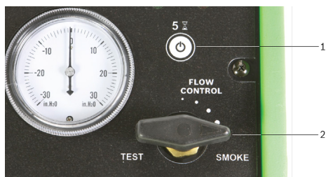
Рис. 9: Регулятор потока дыма полностью открыт
