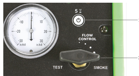
Fig. 9: Regolatore del flusso di fumo completamente aperto
