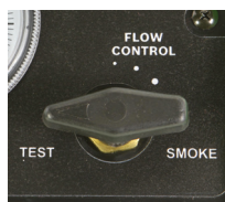
Rys. 2: Regulator strumienia dymu w położeniu "TEST"
