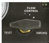
Fig. 2: Regolatore del flusso di fumo impostato su "TEST"
