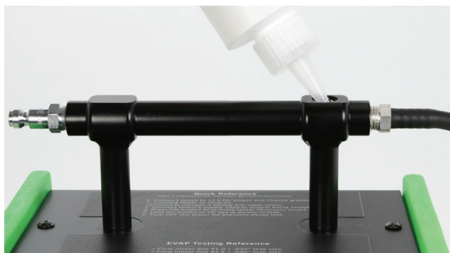
Rys. 5: Napełnianie roztworem dymowym UltraTraceUV®
