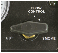
Fig. 2: Régulateur de flux de fumée en position "TEST"
