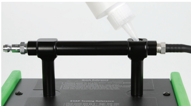
Şek. 5: UltraTraceUV® duman solüsyonunun doldurulması
