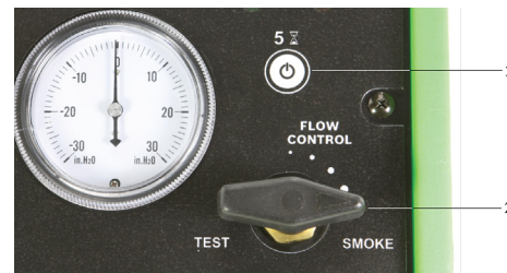
Obr. 9: Regulátor proudu kouře plně otevřený
