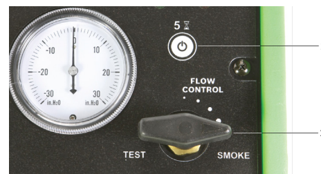
Abb. 9: Rauchstromregler vollständig geöffnet
