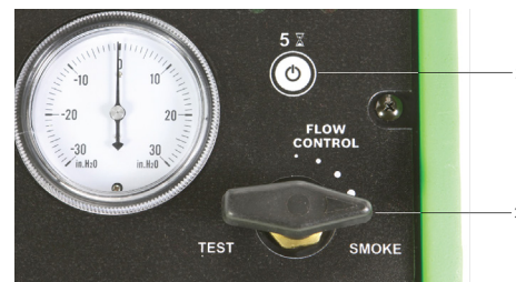
Fig. 9: Regulador de caudal de humo completamente abierto
