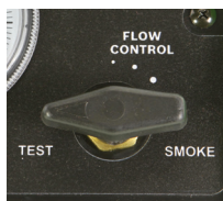
Fig. 2: Røgstrømsregulator i indstilling "TEST"
