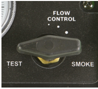
Şek. 2: Duman akımı ayarlayıcısı "TEST" ayarındadır
