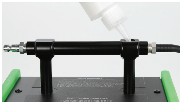
Fig. 5: Riempimento con soluzione fumo UltraTraceUV®
