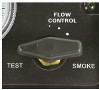
插图 2: “TEST” 设置中的烟气流量控制器
