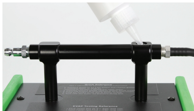
Рис. 5: Заливка коптильной жидкости UltraTraceUV®
