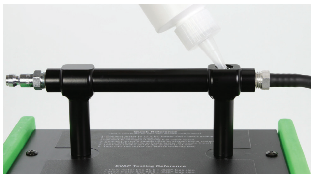
Afb. 5: Vullen met de UltraTraceUV® rookplossing
