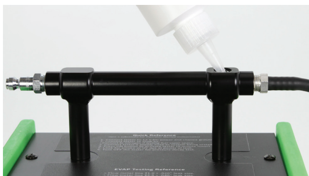
Obr. 5: Plnění roztoku UltraTraceUV® ke generování kouře
