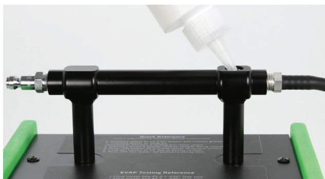
Fig. 5: Verter a solução de fumo UltraTraceUV®
