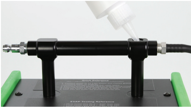
Fig. 5: Fyll på UltraTraceUV®-röklösning
