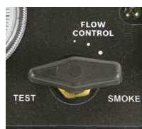
Рис. 2: Регулятор потока дыма с настройкой "TEST"
