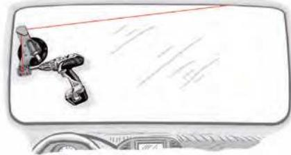
Lad akku skruetrækkeren køre langsomt højre om, tilpas i den forbindelse hastigheden afhængig af belastningen. Hold ved dette arbejde den indvendige udskæringsbeskyttelse mellem udskæringsnoren og instrumentbrættet- hhv. mellem stolpen- og taghimlen således, at der ikke kan opstå skader i kabinen. Fortsæt nu udskæringen indtil udskæringsnoren har nået det nederste højre hjørne.
