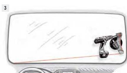
**OBS:** Vær opmærksom på, at udskæringssnoren ikke kan beskadige nogen aggregater, ledninger, slanger og beklædninger ved udskæringen og sikre ruden mod at kunne glide ned!
