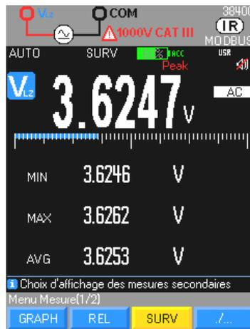
Le mode **SURV** (accessible sous **MEAS...**) surveille les variations d'un signal en enregistrant les extrêmes (**MIN** et **MAX**) de la mesure principale et en calculant sa moyenne (**AVG**).
