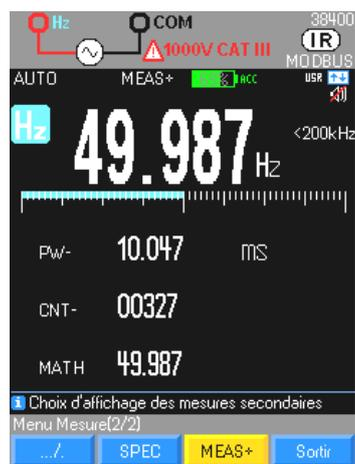
Suivant les conditions de déclenchement du fréquencemètre, mesure de la largeur d'impulsion en ms.
