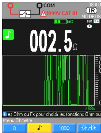
Mesure de la valeur d'une résistance jusqu'à 1000  $\Omega$ , avec indication sonore continue à 4 kHz.
