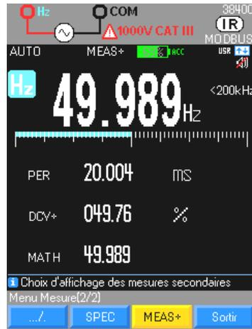
Le mode de rapport cyclique DCY est optimisé pour mesurer les intervalles actifs ou inactifs des signaux de commutation ou des signaux logiques. Les systèmes d'injection carburant électroniques et les alimentations à découpage notamment sont contrôlés par des impulsions de largeur variantes qui peuvent être vérifiées par une mesure de rapport cyclique.
