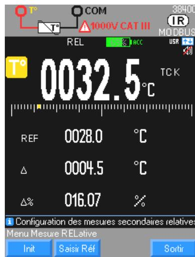
Mesure de la température par le biais d'un thermocouple entre les 2 bornes V et COM en °Celsius
