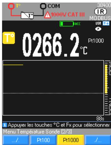
Mesure de la température avec un capteur : Pt100 / Pt1000 ou ./...
