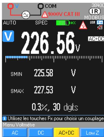
A partir des spécifications techniques internes au multimètre, le mode **SPEC** affiche directement la tolérance de la mesure en cours, sans qu'il soit nécessaire de la rechercher et de la calculer.
