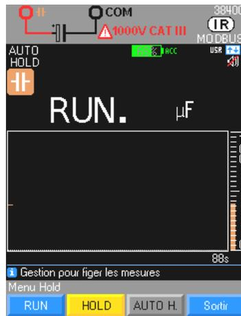
Mesure de la capacité d'un condensateur sur résolution de 1000pts
