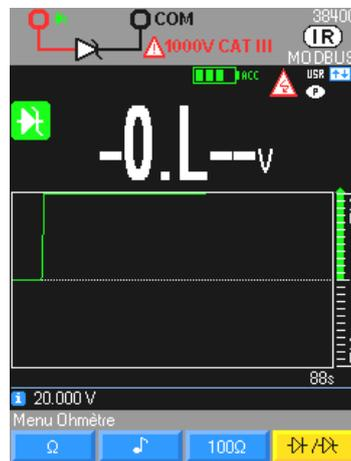
Diode Zener ou LED, la sélection de cette diode est une fonction identique à la diode ci-dessus avec tension maximale de 26 V et courant maximal de 10 mA.
