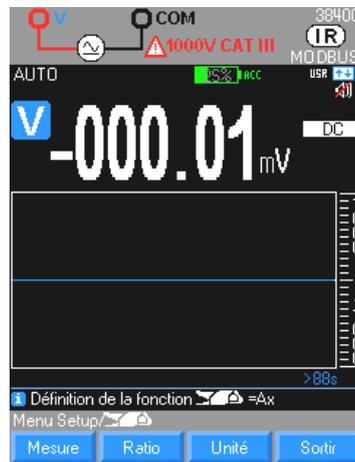
Pour éviter de couper un circuit, il est conseillé de mesurer le courant avec une pince ampèremétrique, sortie A ou V (fonction Ax).
