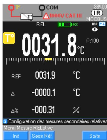
L'afficheur principal et le bargraph horizontal suivent en permanence l'évolution de la mesure.
