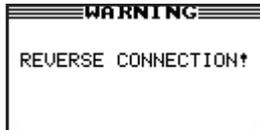
Wenn Sie die Klemmen an den falschen Pol anschließen (positive Klemme an negativen Pol oder umgekehrt), wird auf dem Ladegerät die Meldung **ANSCHLUSS UMDREHEN!** angezeigt.
