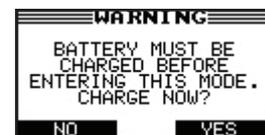
Wenn Sie **JA** auswählen, wird die Batterie im Modus „Diagnose-Ladevorgang“ geladen, bis sie bereit ist. Das Gerät kehrt automatisch zur Anzeige STROMVERSORGUNG zurück, und die Batterie wird auf dem ausgewählten Spannungsschwellenwert gehalten.
