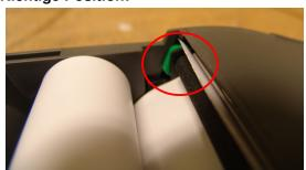
Wenn sich der Schalter in der falschen Position befindet, setzen Sie einen kleinen Schraubendreher zwischen Oberseite des Schalters und Unterseite des Gehäuses an. Drücken Sie auf die Oberseite des Schalters, um ihn umzustellen.
